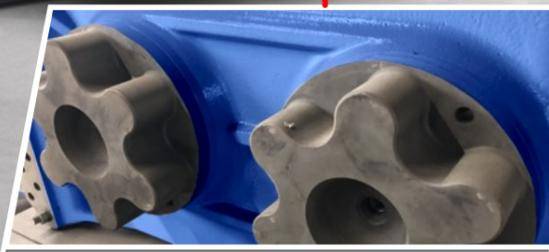
Schweres Synchrongetriebe mit Schnellwechsellahme, um die Welle schnell und mit geringem Aufwand wechseln zu können. Ein Austausch des Brecherwerks kann ohne lange Ausfallzeiten gewährleistet werden.
